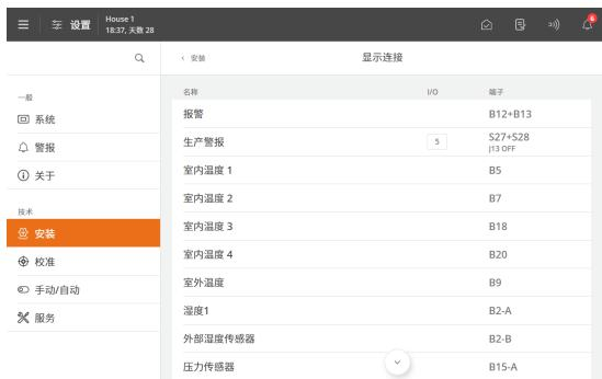
选择 安装 | 手动安装菜单组件，控制器根据列表分配 I/O。这意味着房舍控制器将选择列表上第一个可用的 I/O，并按照组件被选择的先后顺序为组件分配 I/O。
