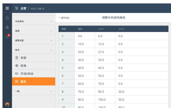
控制器可以根据各自的当前通风需求曲线，调节进风口。因此，您可以使用一个进风口进行冬季通风，两个进风口进行夏季通风。
